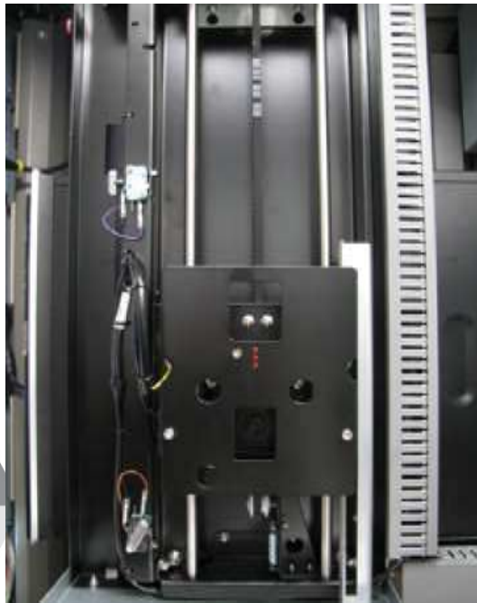
Appareil photo sur verin qui permet un réglage automatique de la hauteur de prise de vue
